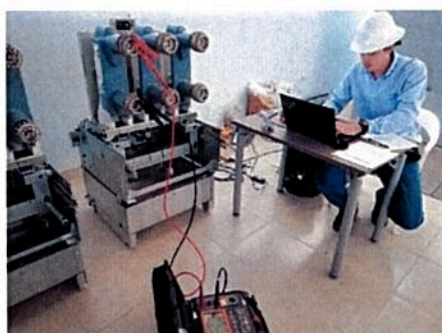
Personal de Siemens prueba resistencia de aislamiento de cámara y resistencia de contactos del interruptor de potencia.
